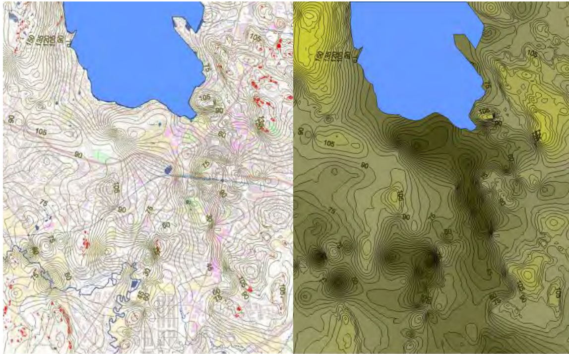
Kuva 1. Kallionpinnan taso esitettyä samanarvokäyrinä karttapohjalla sekä havainnekuvana ilman karttapohjaa (Lahden ja Hollolan alueen pohjaveden virtausmallin päivitys, Artimo et al. 2012).
