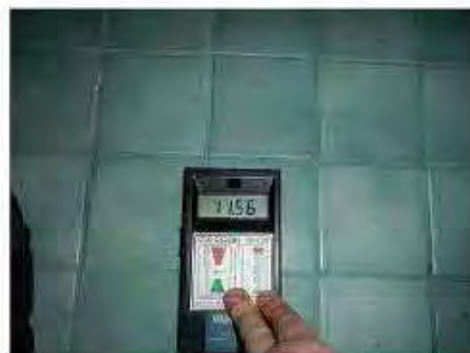
Omakotitalon WC-tilan lattiassa on kohonneita kosteuspitoisuuksia.
