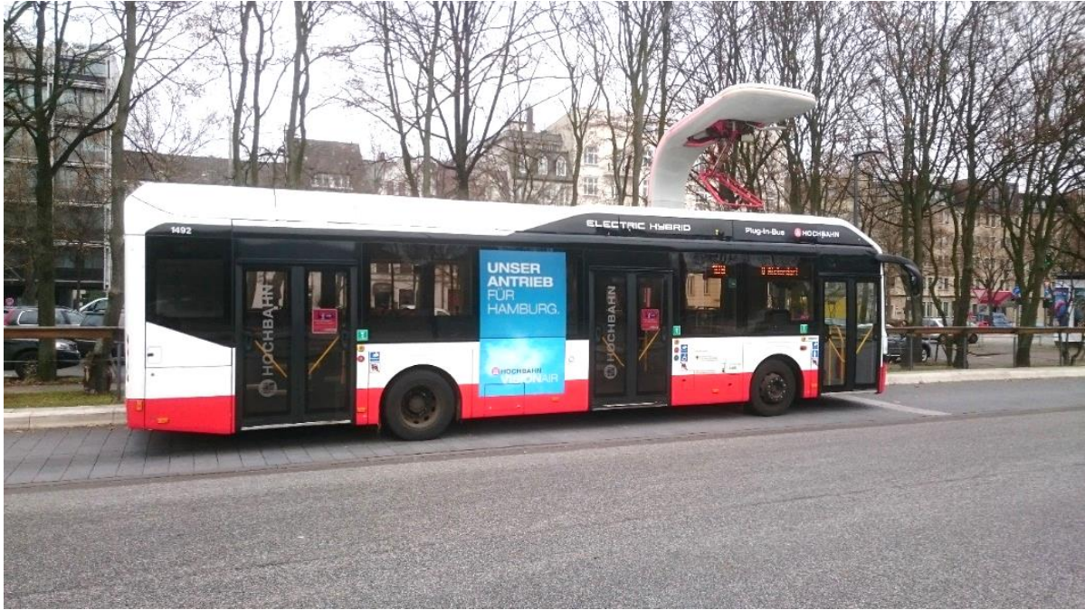
Kuva 22. Ladattava hybridibussi pikalatauksessa Saksan Hampurissa.
