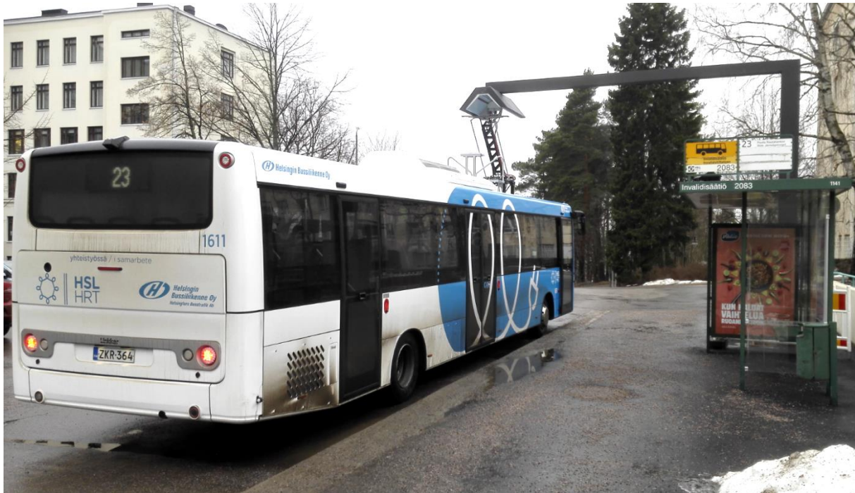
Kuva 17. Täyssähköbussi pikalatauksessa Helsingin Ruskeasuon päätepuskilla.
