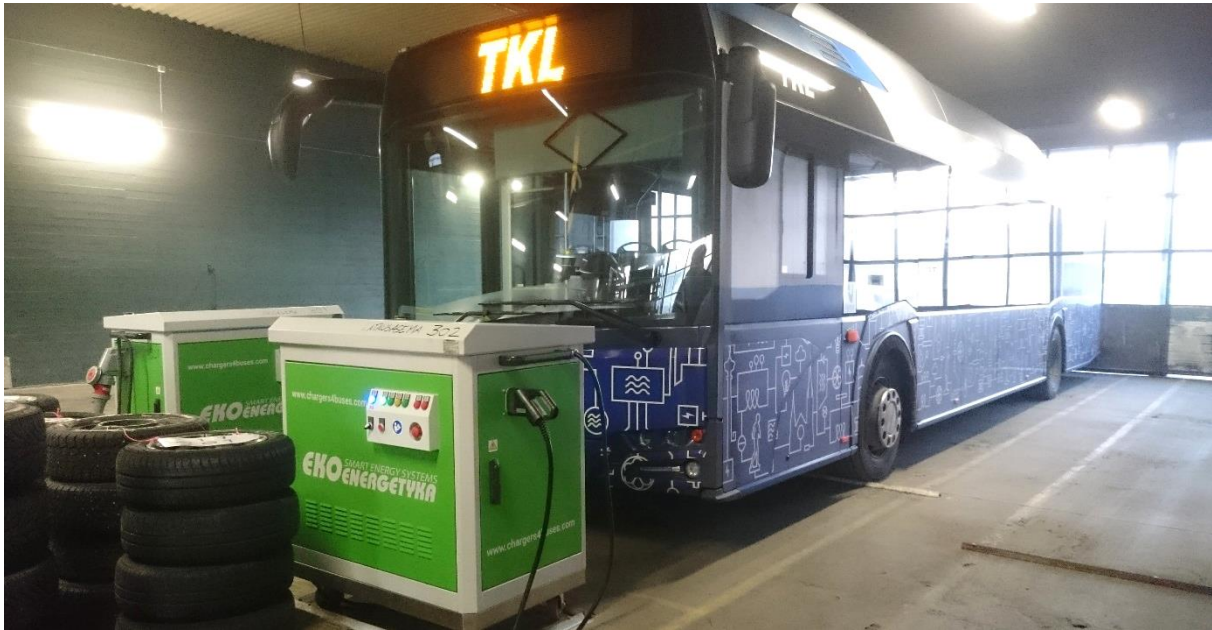
Kuva 18. Täyssähköbussi hidaslatauksessa Tampereella
