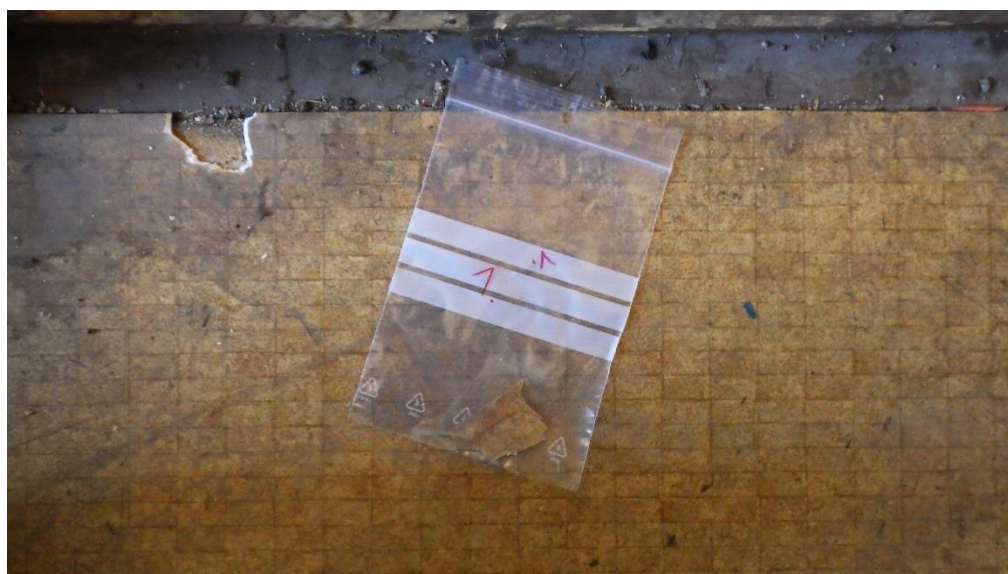
Kuva 4. Lattian ruskean ruudullinen muovimatto 2.krs (näyte 1). Ei sisällä asbestia.
