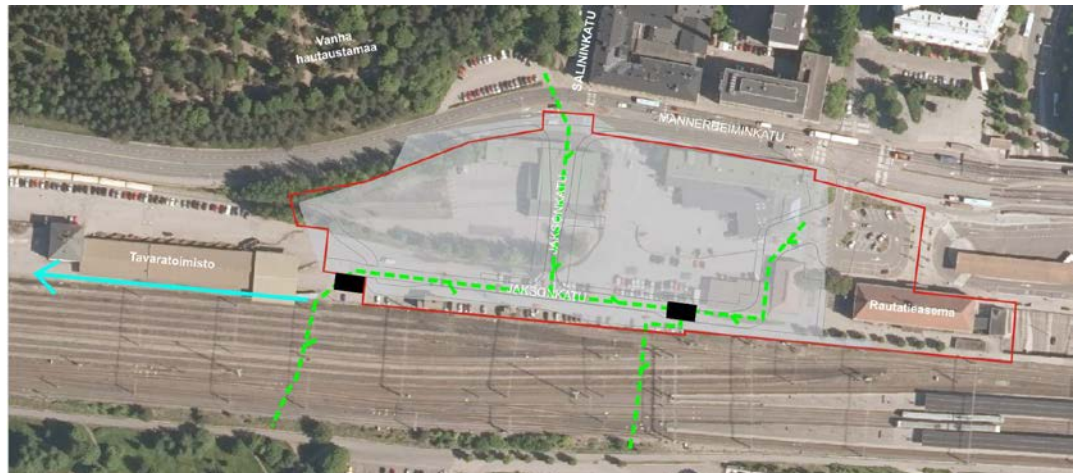
Kuva 70. Jaksonkadun suunnittelualan hulevesijärjestelyjen luonnos. Vihreällä katkoviivalla viemärijärjestelmä, mustalla laatikolla mahdollisten viivytysjärjestelmien sijainnit ja turkooilla tulvareitin suunta.
