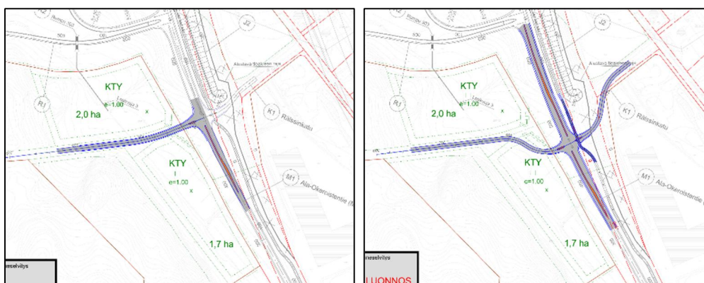
Kuva 16. Vaihtoehdon 2 (nelihaaraliittymä) alavaihtoehdot, joista oikeanpuoleinen todettiin paremmaksi.
