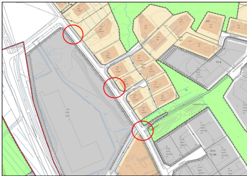
Kuva 20. Vaihtoehto 3, rakenteellisia hidasteita Kyläkunnantielle. Hidastetyyppinä esim. yksipuoleinen pistemäinen ajoradan kavennus (Liikenneviraston ohjeita 35/2017).
